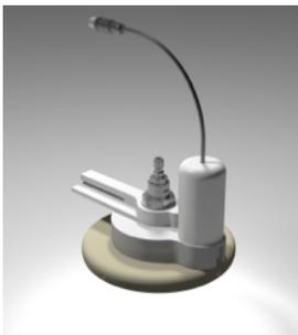
Mit ihren rund 1000 Dampfstrahlen in der Minute entfernt die Drehscheibe sowohl leichte, als auch hartnäckige Verschmutzungen von Mesh Belts. Dabei bleiben ihre Kunststoffscheiben kühl und ermöglichen eine ständige Reinigung. Die Drehscheiben werden mit 24V DC betrieben und sind in verschiedenen Ausführungen verfügbar.
